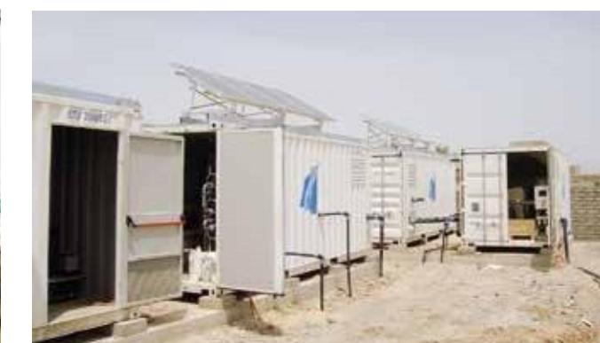
Quartz filtration unit. Unidad de filtración a cuarzo. Mobile drinking plants for labors camps.
