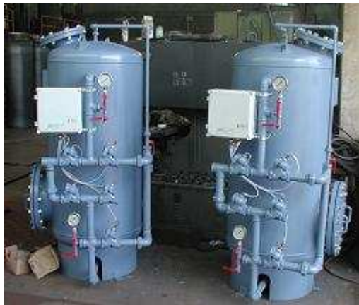
Filtri automatici - portata 15m 3 /h
